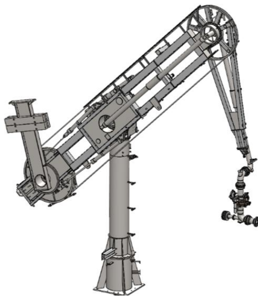
図 1：液化水素用ローディングアーム イメージ
