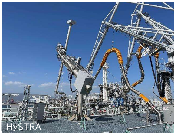
【タンカーと接続中の鋼管型液化水素用ローディングアーム】
