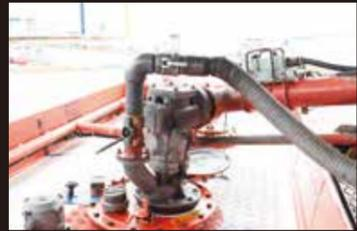
流体（石油・ケミカル類）の荷役の大部分はタンクローリー上部のハッチを大気開放したまま積み込むオープン・トップローディングが採用されています。多量の石油製品を短時間に荷役するのに最適なローディングアームです。
