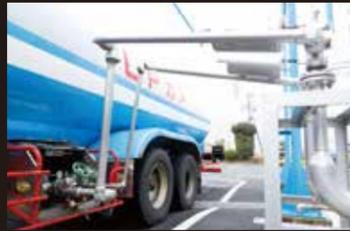
加圧された流体や毒性を有する流体は密封した状態で荷役するクローズド・ローディングを選定。タンクローリーの上部、または下部にリキッドノズルおよびペーパーノズルが設置されています。タンクローリーの上部から荷役するクローズド・トップローディング、下部より荷役するクローズド・ボトムローディングの2種類があります。
