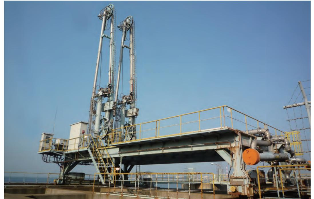
桟橋スペースの制約により、ローディングアームを固定できない場合には、台車上にアームを据付け、荷役時に移動して使用します。台車の種類はレール、タイヤ他、ご要望に応じて対応しています。
