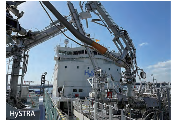
6B 液化水素用ローディングアームの荷役作業
